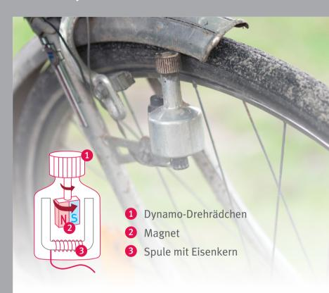
Der Dynamo besteht innen aus einem langen Kupferdraht, der zu einer Spule mit Eisenkern gewickelt wurde. Über dieser Spule befindet sich ein Magnet, der mit dem Rädchen am Gehäuse des Dynamos verbunden ist.
