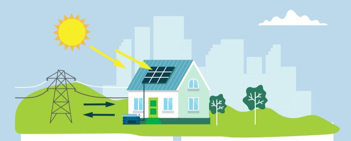
Platten gegen Süden schauen, fangen sie viel mehr Sonne ein. Aufpassen muss man auch, dass die Platten nicht vom Schatten der nahestehenden Bäume oder Häuser verdeckt werden. Je mehr Schatten, desto weniger Strom. Die Platten werden im Fachjargon als Module bezeichnet und mit Kabeln miteinander verbunden.
