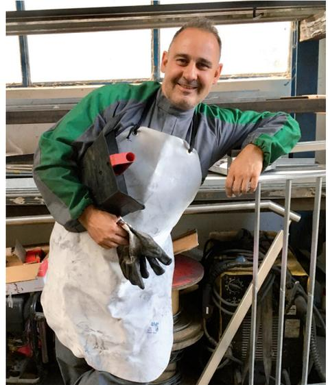
*Typische Schutzkleidung bei kurzzeitigen schweißtechnischen Arbeiten*
