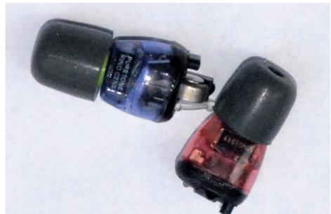
*Aktive Gehörschutzstöpsel, durch ein Mikrofon werden die Umgebungsgeräusche bei Bedarf verstärkt und schädliche Geräusche abgedämpft.*
