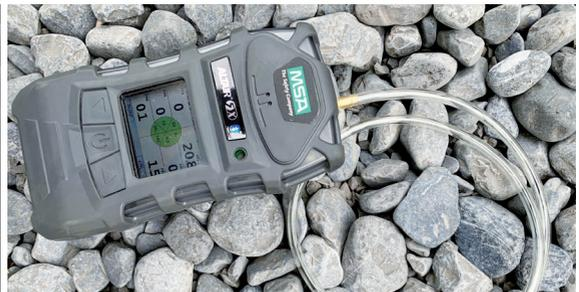
*Gasmessgerät mit 6 Messsensoren ( $O_2$ ,  $H_2S$ ,  $CO$ ;  $VOC$ ,  $SO^2$  und Ex-gefährliche Gase) – vor dem Einstieg in begrenzte Behälter oder Schächte ist immer eine Notfallplanung und auf jeden Fall eine Sondierung mittels Gasmessungs - Detektoren durchzuführen. Die eingesetzten Personen müssen diesbezüglich genauestens unterrichtet und geschult werden.*
