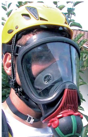
Gasdichte Schutzmaske mit Schutzvisier (gasdicht)
