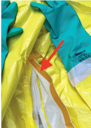
*Sicheres Verschließen des Reißverschlusses mittels Klebefolie bei Schutzkleidung*
