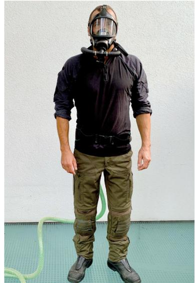
Spezielles Frischluftschlauchgerät der Firma MSA
