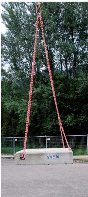
Beachten Sie, dass bei der Verwendung von Mehrstrang-Anschlagmittel diese selten alle gleichmäßig belastet sind. Diesbezüglich finden Sie später in der Broschüre Informationen zur richtigen Bemessung der Anschlagmittel.
