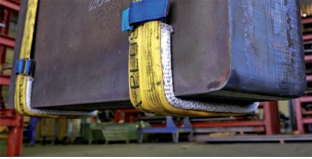
Zur Erhöhung der Abrieb- und Schnittfestigkeit können Beschichtungen oder Überzüge aus schnittfesten Kunststoffen oder Textilien aufgebracht werden.
