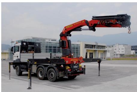
*N.B.: Setzen Sie immer alle Stabilisatoren ein! Beachten Sie vor dem Einsatz der Maschine auch die spezifischen Angaben des Herstellers...sowie die Angabe der Einsatzmöglichkeiten.*
