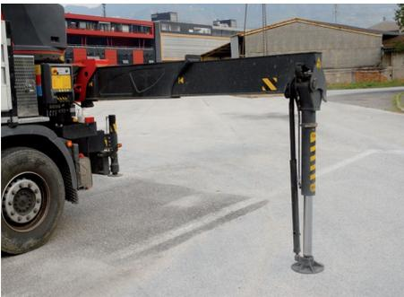
Ladekrane mit Abstützungen dürfen im Allgemeinen nicht freistehend, d.h. ohne Benutzung der Abstützungen betrieben werden. Die beim Kranbetrieb auftretenden Verwindungskräfte müssen von der Tragkonstruktion der Abstützung aufgenommen werden. Andernfalls verwindet sich der Fahrzeugrahmen unzulässig und es kommt zu Rahmenschäden. Negative Veränderungen des Fahrverhaltens können die Folge sein.
