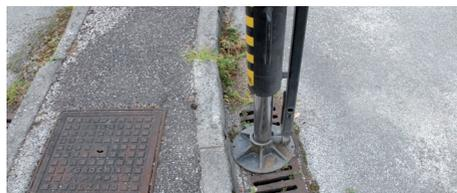
**Bild: Setzen Sie NIE die Stabilisatoren auf Kanten oder Schächte ein!!!**
