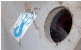
Vorgegebener Anschlagpunkt des Maschinenherstellers zum Kranhub.
