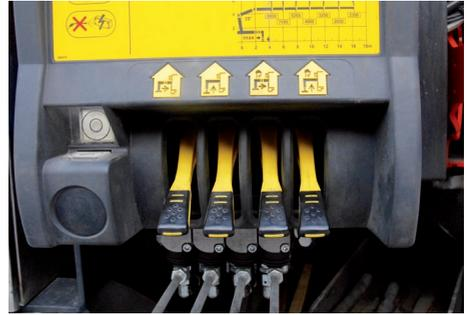
Bei Kränen mit mehreren Steuerständen besteht die Gefahr gegenseitiger Eingriffe in die Steuerung. Dies gilt auch für Ladekräne. Darum müssen Steuereinrichtungen von Kränen mit mehreren Steuerständen gegeneinander verriegelt sein. Dies gilt auch und insbesondere, wenn der Ladekran zusätzlich zu den ortsfesten Steuerständen mit einer Fernsteuerung ausgerüstet ist.
