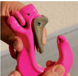
Kontrolle der Funktion der Verschleißeinrichtung
