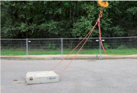
Schleifen Sie nicht Lasten über den Boden – reißen Sie nicht festgebundene oder festgefrorene Lasten los.
