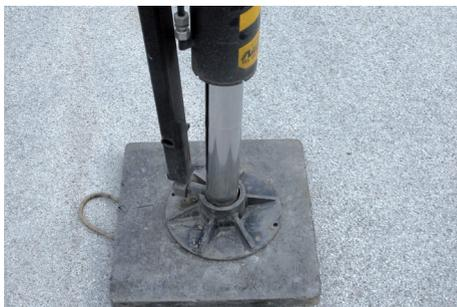
Überprüfen Sie immer die Stützen und den Untergrund vor dem Kraneinsatz. Verwenden Sie, wenn notwendig, den Bodenverhältnissen geeignete Unterlegeplatten.
