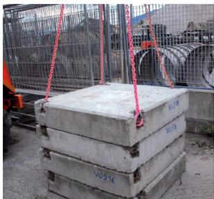
Kettenverkürzungsklauen ohne Sicherung können im entlasteten Zustand auf dem Boden liegend die Kette frei geben. Es sind möglichst verriegelbare Kettenverkürzungsklauen zu benutzen.
