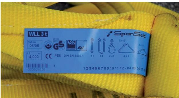
Jede genormte Hebeschlinge muss über ein leserliches Etikett verfügen
