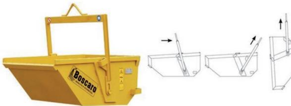
Der Kübel wird auf den Boden gestellt und das Hubsystem entlastet. Der Hubarm wird dann nach hinten geschwenkt, dann kann der Behälter angehoben und entleert werden. Der Vorteil ist, dass keine Hilfs-
