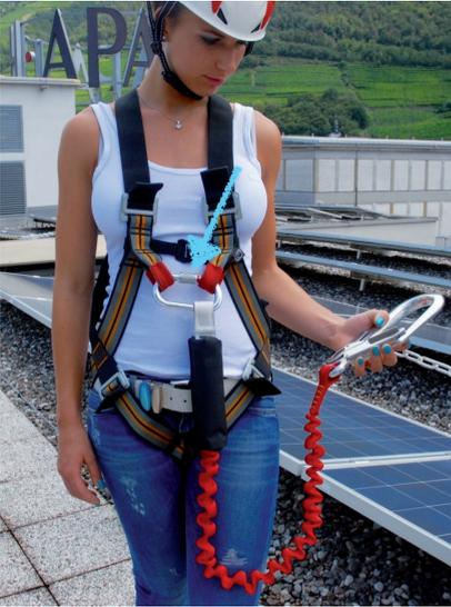
In diesem Beispiel ist ein Standardkarabiner verwendet worden und ist in eine statisch ungünstige Position „verrutscht“: so könnte dieser bei einem Absturz nur mehr einen Fangstoß von 6kN aufnehmen (entlang der längeren Seite hingegen min. 15 kN); Außerdem ist der Karabiner nicht verschlossen (siehe die rote Markierung des Herstellers). Dies hätte zur Folge, dass sich die Sicherungsschnappe durch einen Schlag öffnen ließe und so das Seil freigäbe.
