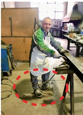
**Ungünstige Kabelführung:** Bildet das Schweißkabel Schleifen um Teile des Körpers, dann kann eine höhere Exposition als vom Hersteller angegeben entstehen.
