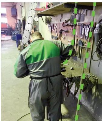
**Empfohlene Kabelführung:** Eine oberhalb des Schweißers installierte Zugentlastung des Kabels erleichtert das Schweißen und garantiert zudem, dass der vorgesehene Sicherheitsabstand zur Schweißleitung zum Kopf des Arbeiters eingehalten wird.
