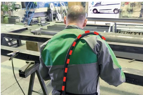
**Ungünstige Kabelführung:** Die Schweißleitung wird über die Schulter gelegt bzw. in die Nähe des Kopfes geführt, um eine Zugentlastung zu erreichen. Durch die Führung der Leitung am Körper kann eine höhere Exposition, als im Datenblatt des Herstellers angegeben, entstehen. Außerdem ist das Stromrückflusskabel am Werkstück entfernt von der Schweißstelle angebracht.
