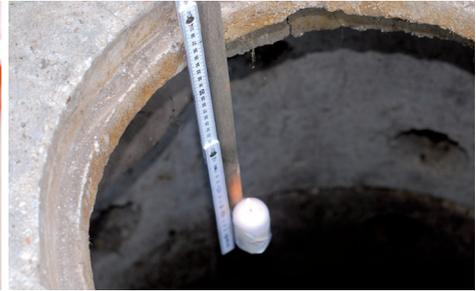
Überholte und gefährliche „Sauerstoffmessung“ mittels Kerze; dies könnte zu einer Zündung von explosionsgefährlichen Gasen führen.
