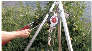
*Dreifuß mit Höhensicherung und integrierter Rettungswinde*
