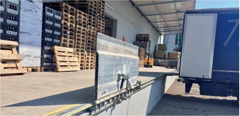
**Verschiebbare Verladehilfsrampen garantieren eine sichere Handhabung und können beim Beladen nicht verrutschen.**
