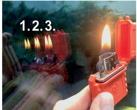
**Glasflächen (Fenster, Fenstertüren, Glaswände, usw.) müssen mit Sicherheitsverglasungen versehen sein. Hier im Bild sehen Sie einen einfachen Test, um den Aufbau der Verglasung leicht festzustellen; halten Sie ein Feuerzeug neben die verglaste Fläche und beobachten Sie die Flammenspiegelung. In diesem Beispiel: 3 gedoppelte Flammen bedeuten 3 Doppelverbandscheiben.**
