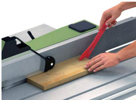
*N.B.: utilizzate l'apposito spingitoio a bacchetta per il taglio di pezzi di ridotta larghezza*
