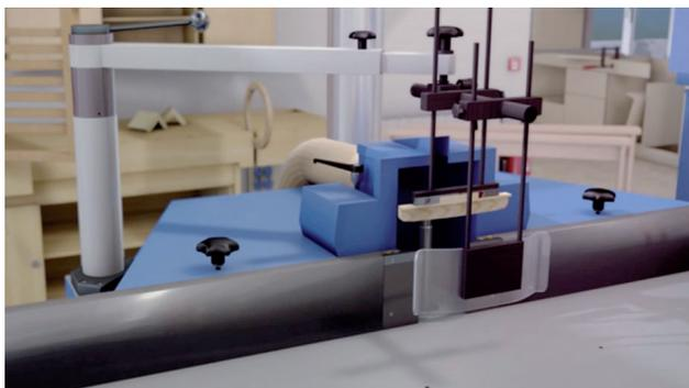
*Esempio di carter di protezione utensile posizionato davanti alla guida e al gruppo pressore*
