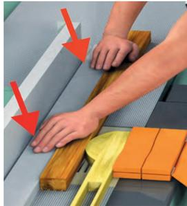
*N.B.: durante la piallatura e la sgrassatura di pezzi di ridotto spessore, coprire sempre l'albero portacoltelli con il pressore a molla. IMPORTANTE: utilizzare la guida ausiliaria come appoggio per le dita.*
