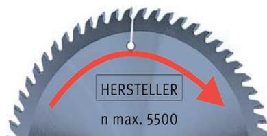
*N.B.: non superare la velocità di rotazione massima indicata sulla lama e prestare attenzione al senso di rotazione indicato.*
