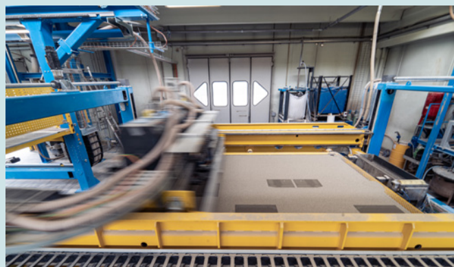
Stampante 3D per elementi prefabbricati in calcestruzzo nello stabilimento di Progress SPA a Bressanone © Progress
